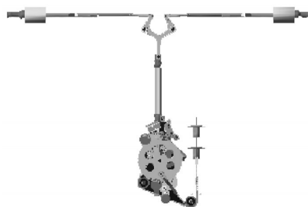
图2 弹簧操动机构仿真模型
